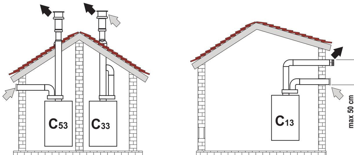
рис. 35- Примеры подсоединения с помощью отдельных труб
