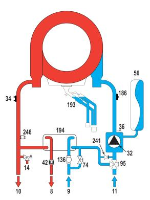
рис. 63- Гидравлический контур
