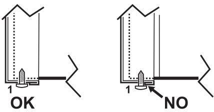
рис. 42- Правильное положение передней панели
