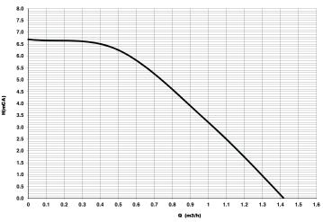
рис. 64- Остаточный напор, достигаемый в системе
