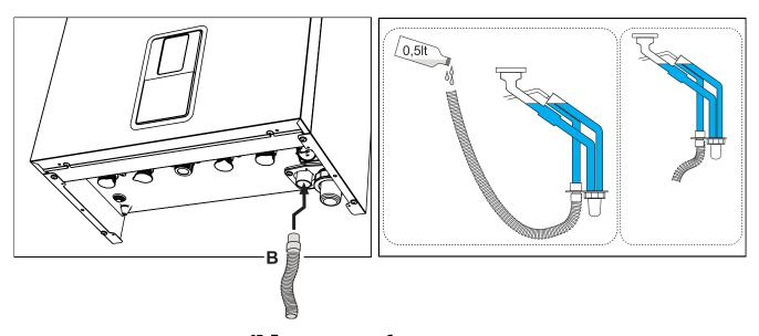
рис. 37- Подсоединение трубы для слива конденсата
