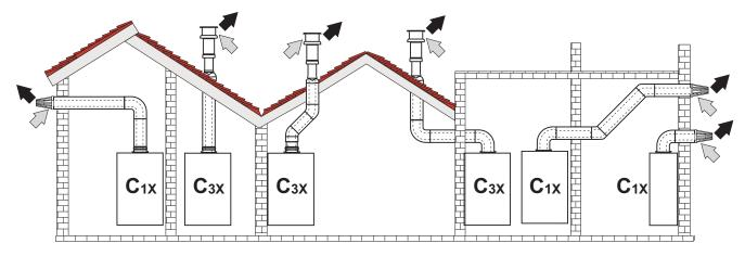
рис. 30- Примеры подсоединения с помощью коаксиальных труб (🕽 = Воздух/ 🖚 = Дымовые газы)
