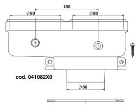
рис. 33- Исходная принадлежность для раздельных труб
