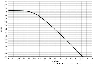
рис. 65- Остаточный напор, достигаемый в системе
