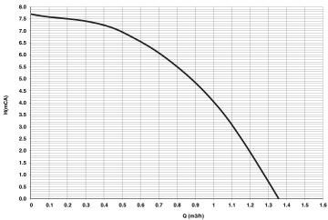
рис. 66- Остаточный напор, достигаемый в системе
