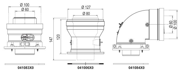
рис. 31- Исходные принадлежности для коаксиальных воздуховодов
