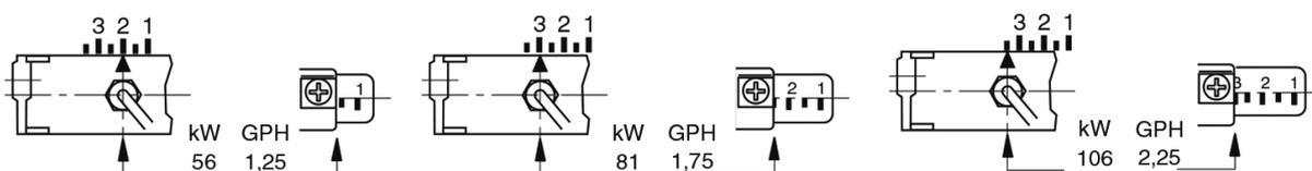
Необходимо проверить горение и при необходимости подкорректировать количество воздуха при помощи регулировочного винта воздушной заслонки.
